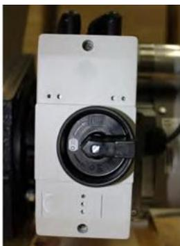
粉碎室粉碎室扉を締め、受皿を取り付け後、電源スイッチをオン (I) に回すと、モーターがオンになり、機械は起動し始めます。
