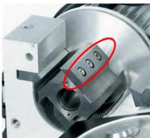
2. 回転刃に付属する刃の六角穴付ネジ(M8)を緩めます。
