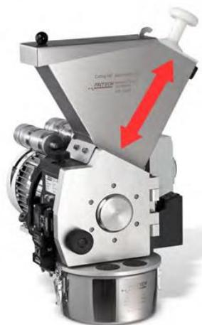
7. 押込み棒をゆっくり下げ、ホッパー内に残っている試料を粉砕室内に押し込みます。
