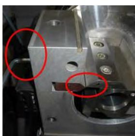
2. 回転刃に付属する刃 1 枚の刃先と左固定刃の刃先が合うまで回転刃を回転させて向かい合わせ、刃先の端同士を平行にさせてください。
